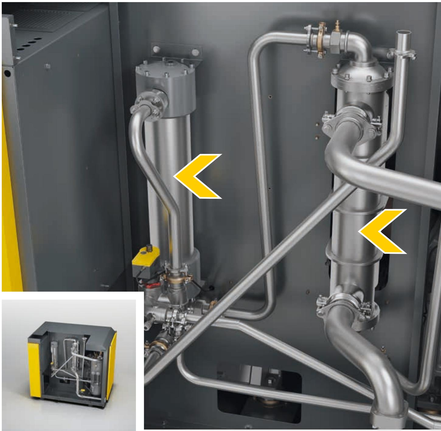
Permutadores de calor de feixe de tubos, em liga de cobre-níquel (CuNi10Fe) são menos vulneráveis a sujidades nos permutadores de calor de placas com capacidade de arrefecimento adequada, no entanto são notoriamente mais robustos e podem ser limpos mecanicamente. Para
