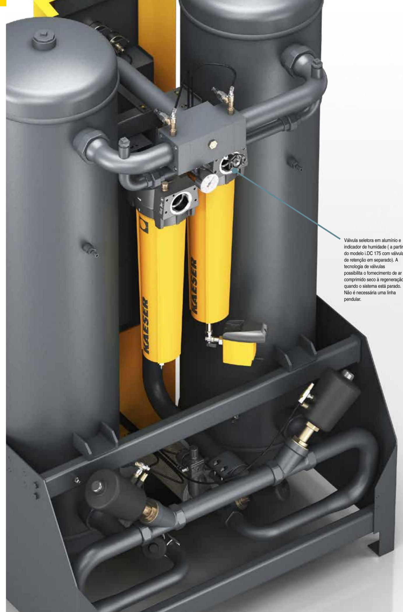
Válvula seletora em alumínio e indicador de humidade (a partir do modelo i.DC 175 com válvulas de retenção em separado). A tecnologia de válvulas possibilita o fornecimento de ar comprimido seco à regeneração, quando o sistema está parado. Não é necessária uma linha pendular.
